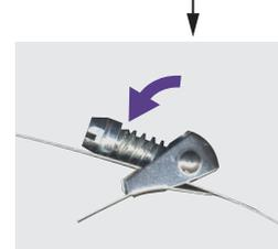
倒してドライバーで締める
