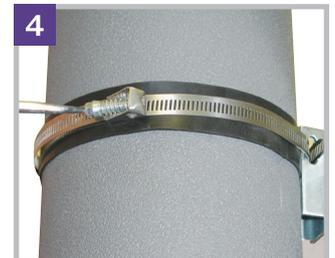
4 ステンレスバンドを引き、ハウジングを横に倒してドライバーで締めて固定する。
